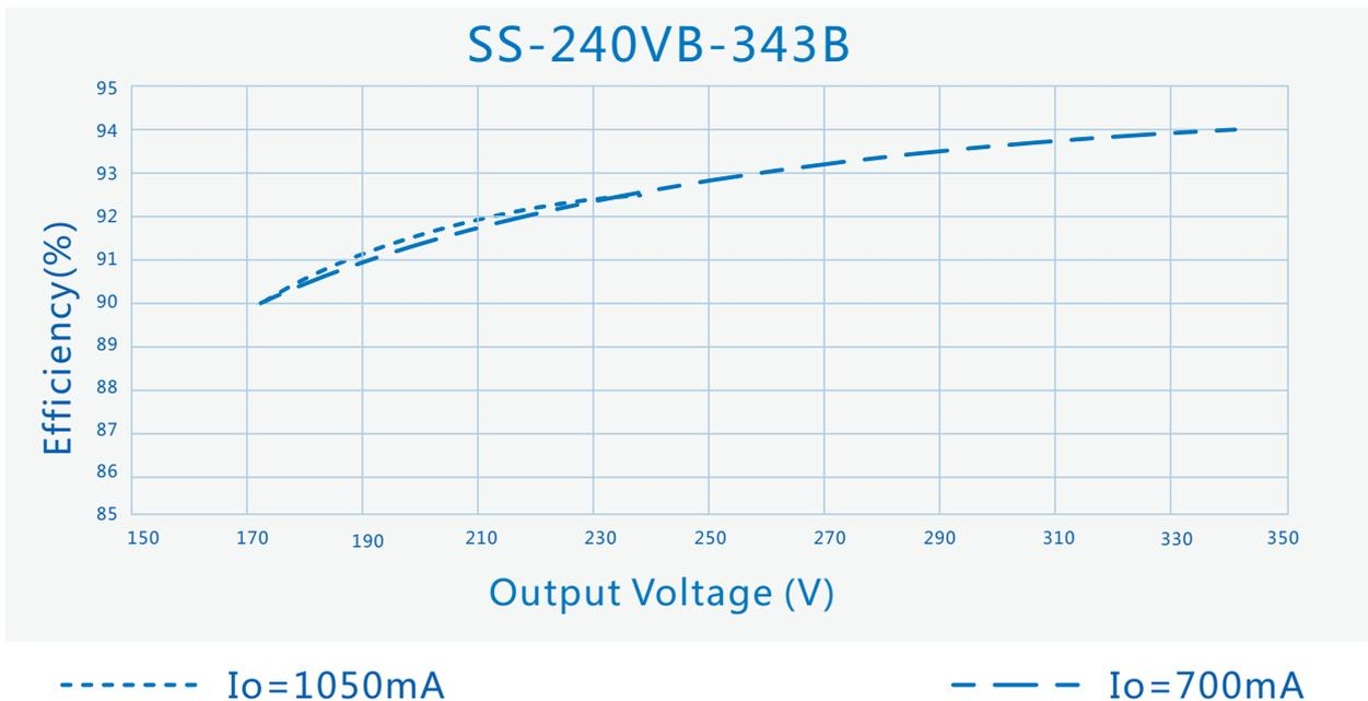
效率 Vs. 输出电压 ( $V_{in}=277V_{ac}$ )
